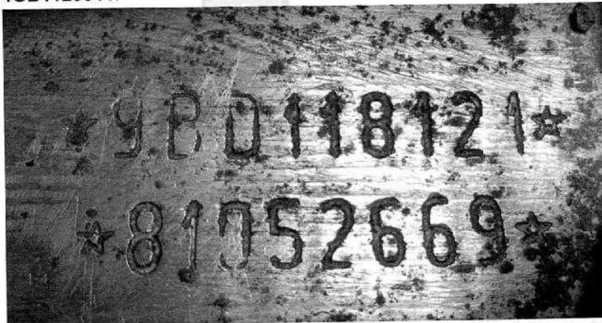
Fotografia ilustrativa de nº 02 – Mostra detalhes da gravação do NIV adulterado inicialmente observado no veículo.
