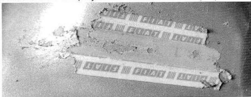
Fotografia ilustrativa de nº 05 – Mostra detalhes de uma das etiquetas adesivas de segurança danificadas.
