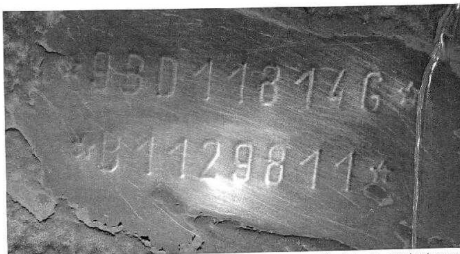
Fotografia ilustrativa de nº 03 – Mostra em detalhes a gravação latente original revelada pelo verso da peça suporte do NIV.
