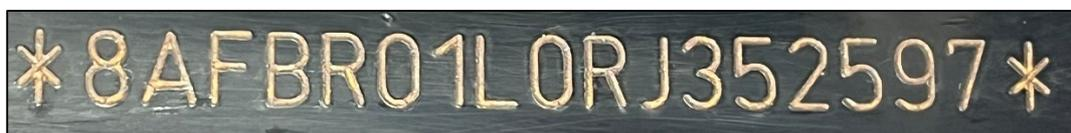
**Figura 3** – NIV gravado no veículo examinado (8AFBR01L0RJ352597).
