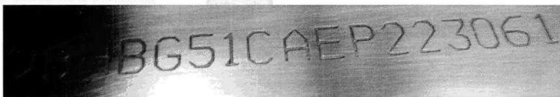
Fotografia ilustrativa de nº 02 – Mostra detalhes da gravação do NIV adulterado inicialmente observado no veículo.
