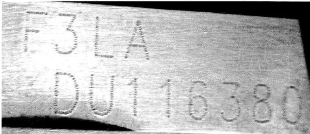
Fotografia ilustrativa de nº 05 – Mostra detalhes da gravação da Sequência Alfanumérica Identificadora do motor observada no veículo.
